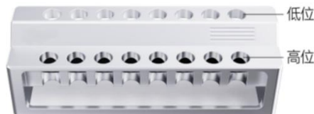
图 3. 磁力架位置示意图（适用于八联管）
