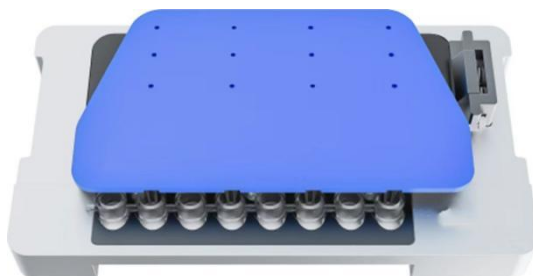
图 2. 加盖芯片示意图
